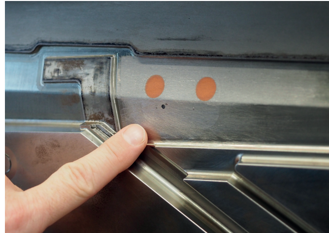
Bild 4. Macht den Unterschied: Einer der insgesamt 19 Sensoren, die im Werkzeug verbaut sind.
